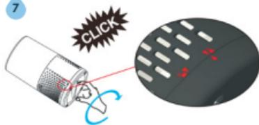
Cierre la cubierta inferior. Gire en el sentido de las agujas del reloj hasta que la cubierta inferior llegue a "f" y al escuchar un "clic".
